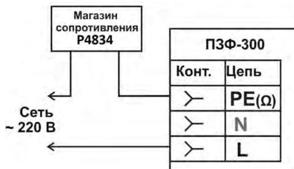
Рисунок 6.10.4 – Схема определения погрешности измерений напряжения прикосновения
